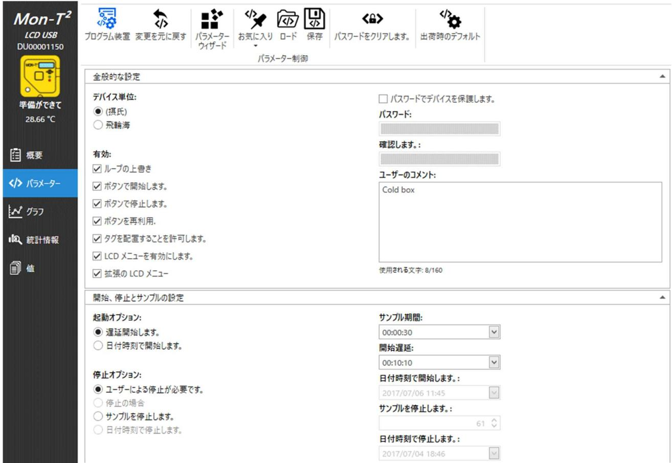
4. 一度設定したプログラムを、《プログラム装置》アイコンをクリックして、ロガー本体にセーブさせます。
